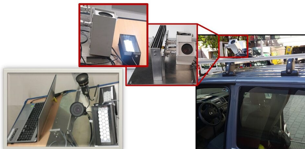
Abbildung 7: ABOUT – Vision-basiertes System zur Tunnelüberwachung
