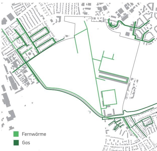
Abb. 65: bestehendes Fernwärme- und Gasnetz im Bereich Spinelli
