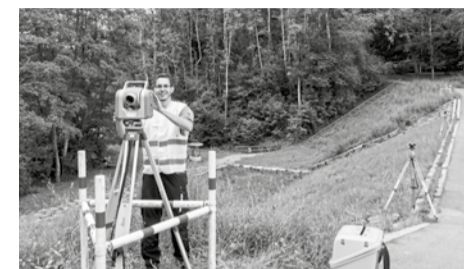
Andreas Krug bei den Deformationsmessungen auf dem Dammbesuch des Hochwasserrückhaltebeckens. Foto: Marius Beißwenger
